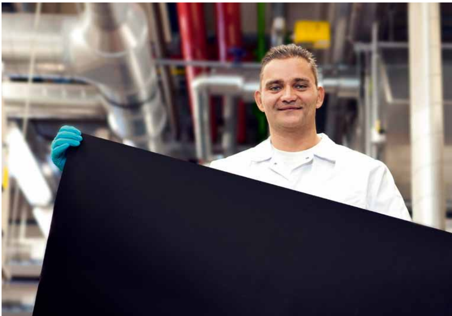
Sichtlich stolz zeigt Industriemeister Roberto Warthe eine Sauerstoffverzehr Kathode, die auf den Transport nach Schanghai wartet. Dort produziert Bayer MaterialScience mit Hilfe des innovativen Verfahrens jährlich über 200.000 Tonnen Chlor aus Salzsäure
